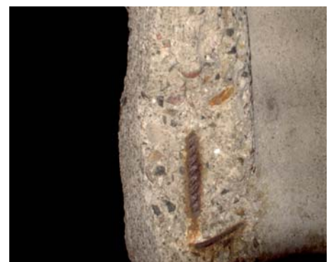
Von außen nach innen schreitet die Carbonatisierung fort
