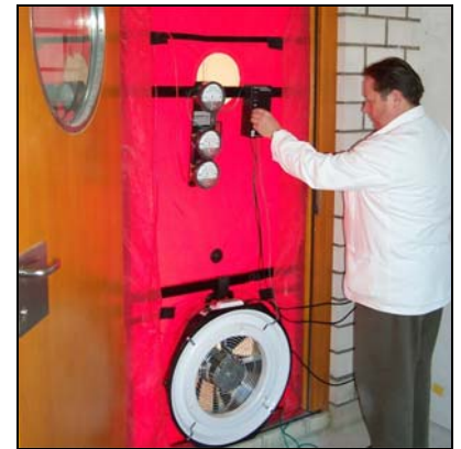
eingebaute Blower Door
